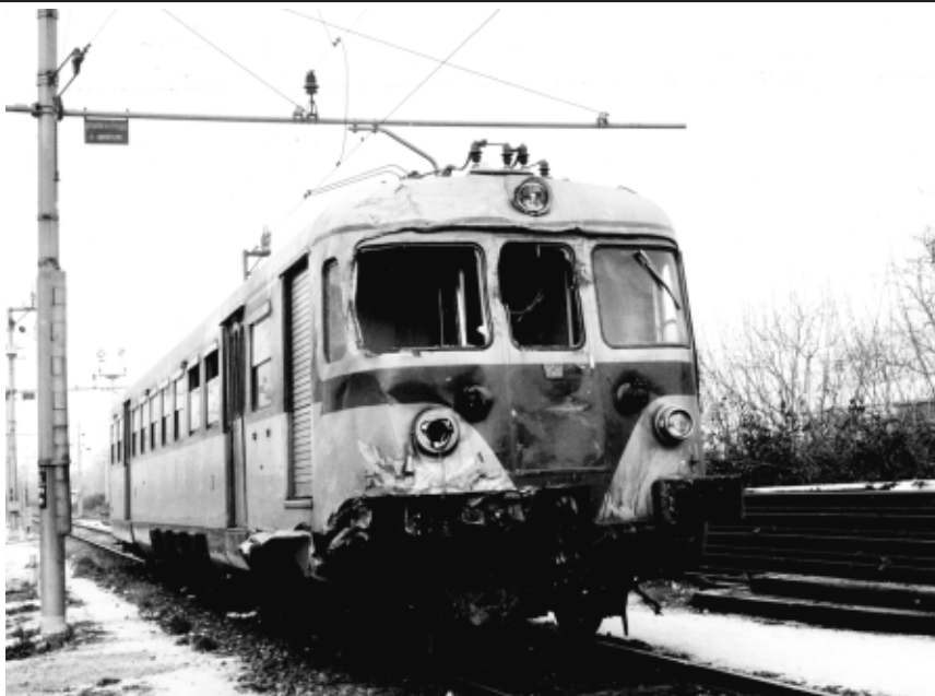
A seguito del sinistro l'elettromotrice di spinta dovette subire l'...amputazione di una cabina di guida divenendo così unidirezionale ed abbisognavole quindi di essere sempre accoppiata ad una vettura pilota, ossia dotata di posto di guida ad una estremità (foto alfa).
