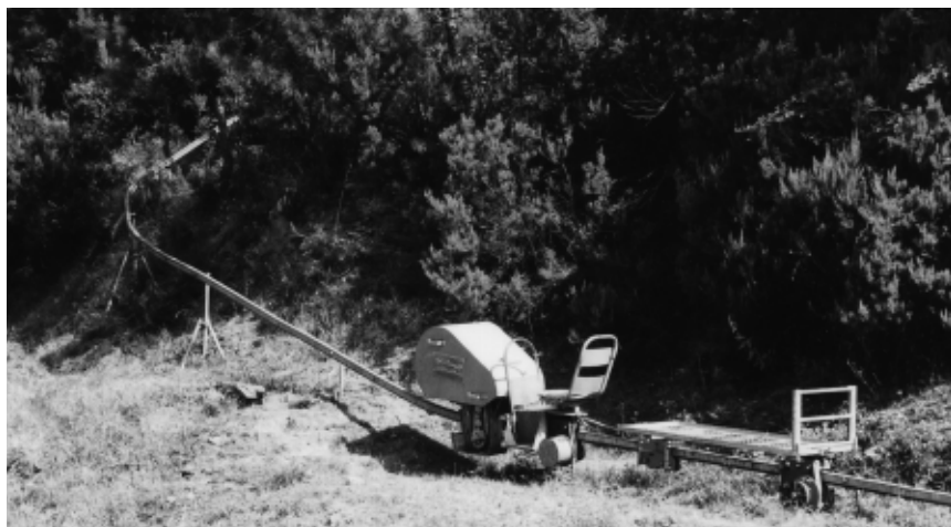
La monorotaia è in grado di superare forti pendenze anche trainando pianali con carichi (foto alfa).
